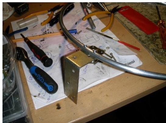
Im nächsten Schritt wird die Delta-Anpassung vorbereitet. Abmessen, Ablängen, Verösen, Verschrauben und Verlöten.
