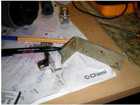
Zuerst wird der Winkel vorbereitet und gebohrt, damit alles montiert werden kann. Es erfolgt die Anpassung an die N-Normbuchse und an die Masthalterung. Das Alu Rohr wird später hier auch verschraubt.
