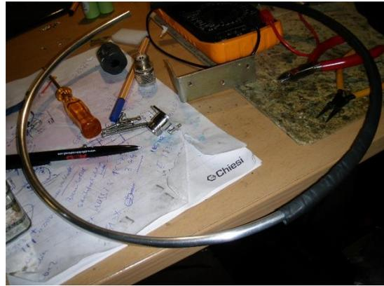
Danach wird im Mittelteil eine Stelle abgeflacht, damit später das Rohr stabil auf dem Trägerwinkel sitzt. Die Löcher werden auch gleich passend gebohrt. Und die Montage mit dem Winkel und der N-Norm Buchse kann stattfinden.
