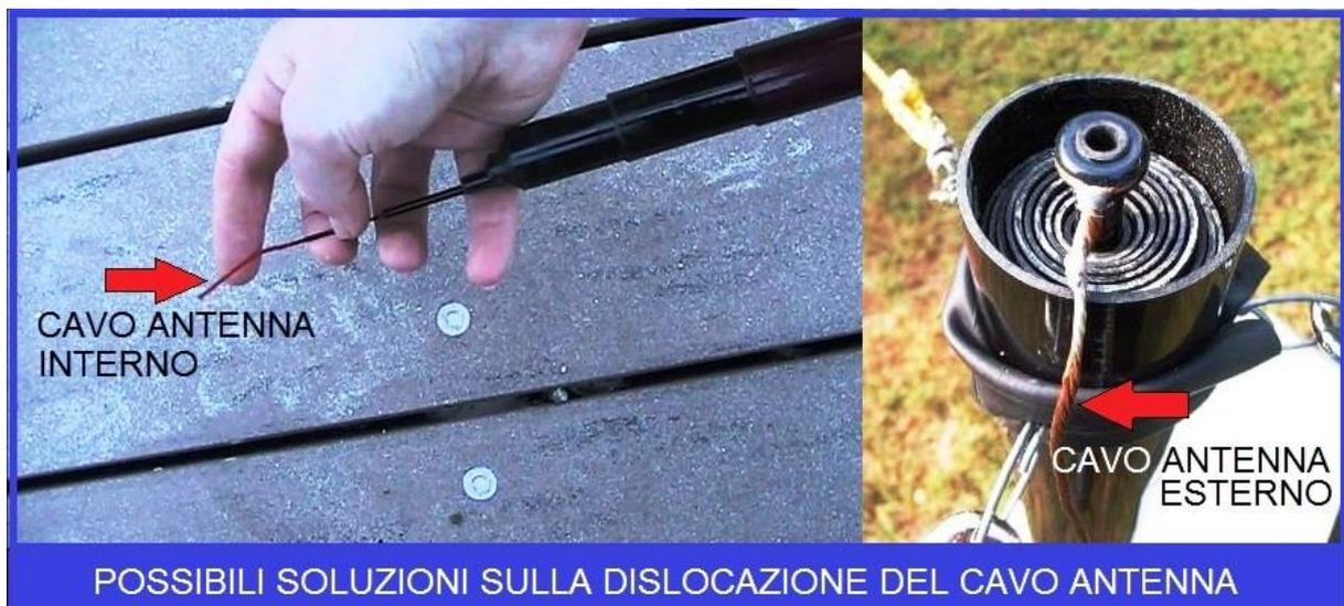
**(mögliche Lösung für die Lage des Antennenkabels)**
