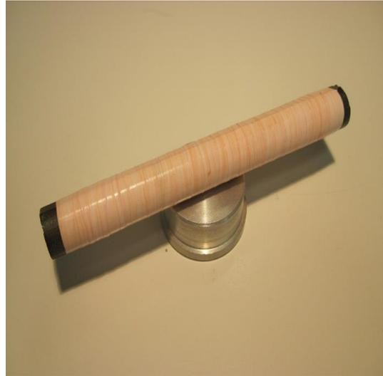
Schneiden Sie zwei Stücke Teflonisierte Drähte von je 80-cm ab (1,25-1,50 qmm in 2 Farben schwarz-rot). Dieser Kabeltyp ist bei Dx-Wire Ptfе Litze AWG16 rot & schwarz Art.-Nr. 16.013-16.014 erhältlich.
